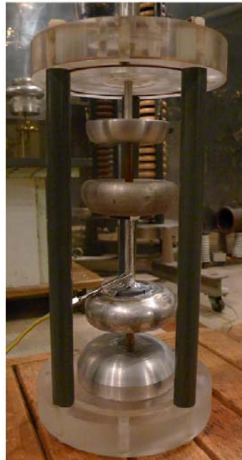
Bild 95: Prüfaufbau zur TE-Messung an Isolierfolie
