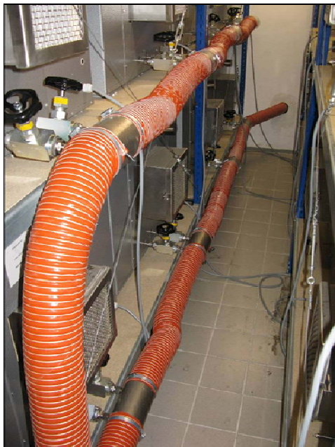
Bild 6: Versuchsanlage bestehend aus Wärmeschränken, Stickstoffaufbereitung und Versorgungsleitungen
