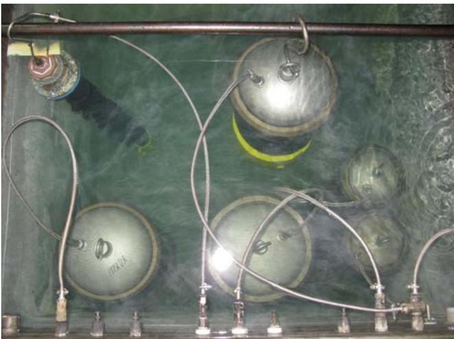
Abbildung 3: Zeitstand-Innendruckversuch
