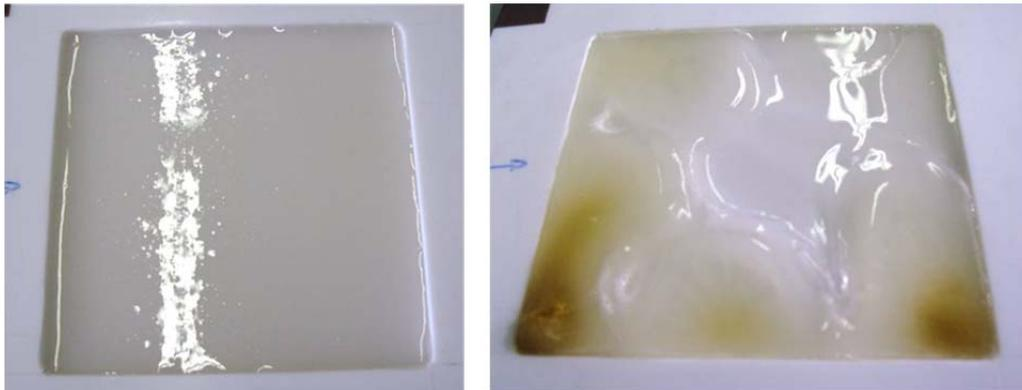
Abbildung 5.34: Folgen inhomogener Feldverteilung (Rapid P1T Vergussmasse / Ring-Schlitz- Hohlleiter)
