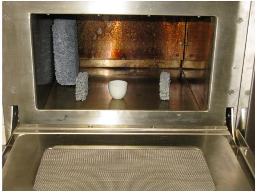
Abbildung 6.16: Positionierung der Proben in der Kammer und geöffnetes Fenster (durchlässig zur IR-Messung)
