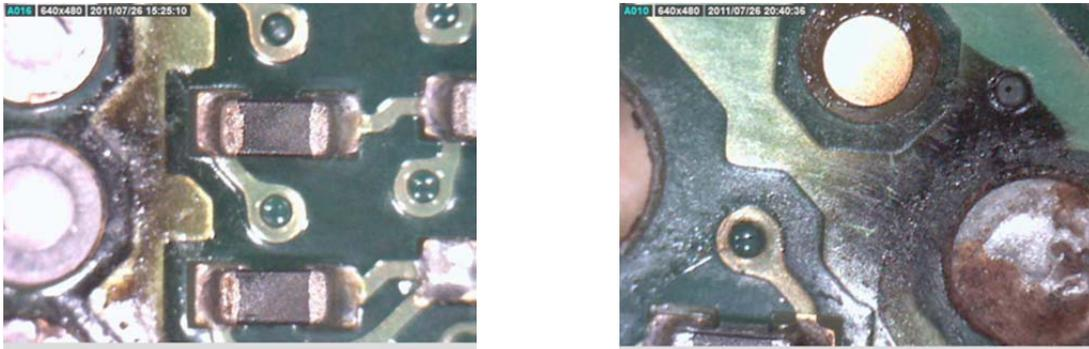
Abbildung 6.31: Verbrennungen neben bzw. zwischen Durchkontaktierungen und eingelöteten Stiften
