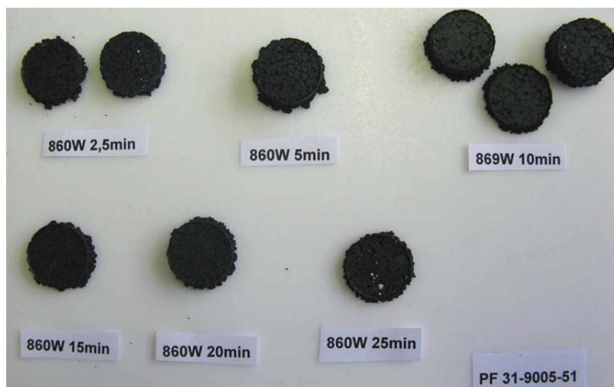
Abbildung 5.79: Vorversuche PF 31-9005-51, Phenolformmasse
