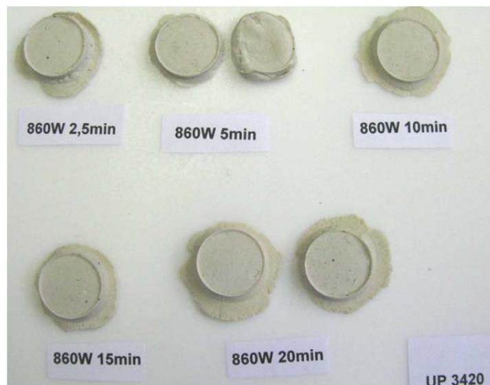
Abbildung 5.76: Vorversuche UP 3420, Polyesterformmasse
