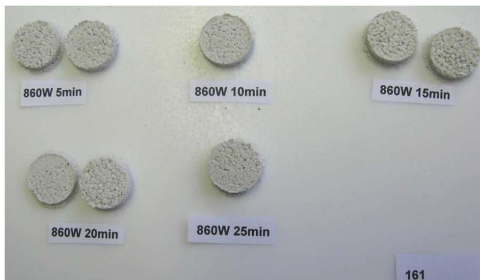
Abbildung 5.81: Vorversuche Formmasse 161, Harnstoffharz-Formmasse
