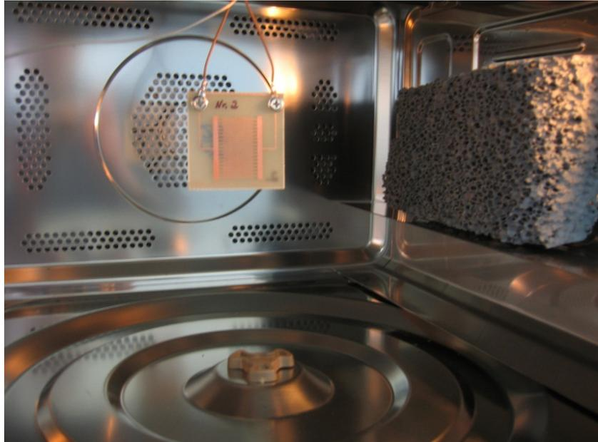
Abbildung 6.10: SiC Absorptionsversuche mit FR4 Testplatine – Mikrowelle 90W
