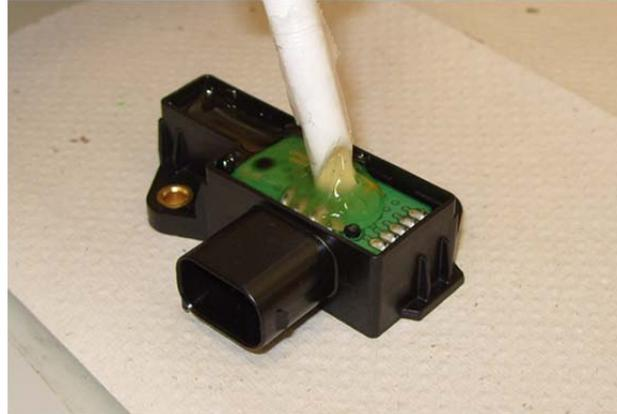
Abbildung 6.29: Manueller Verguss eines Sensormoduls
