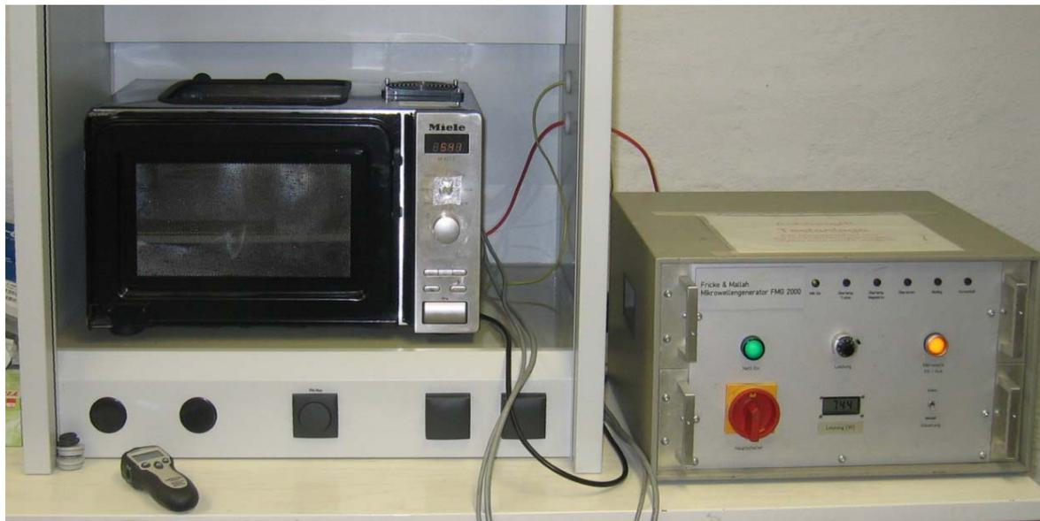
Abbildung 6.12: Durch externen Generator regelbare Mikrowellenanlage des Partners Fricke & Mallah
