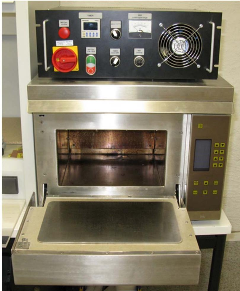
Abbildung 6.15: Labor-Mikrowellenmodul der Fa. Fricke und Mallah mit regelbarer Mikrowellenleistung und hybrider Konvektionsheizung
