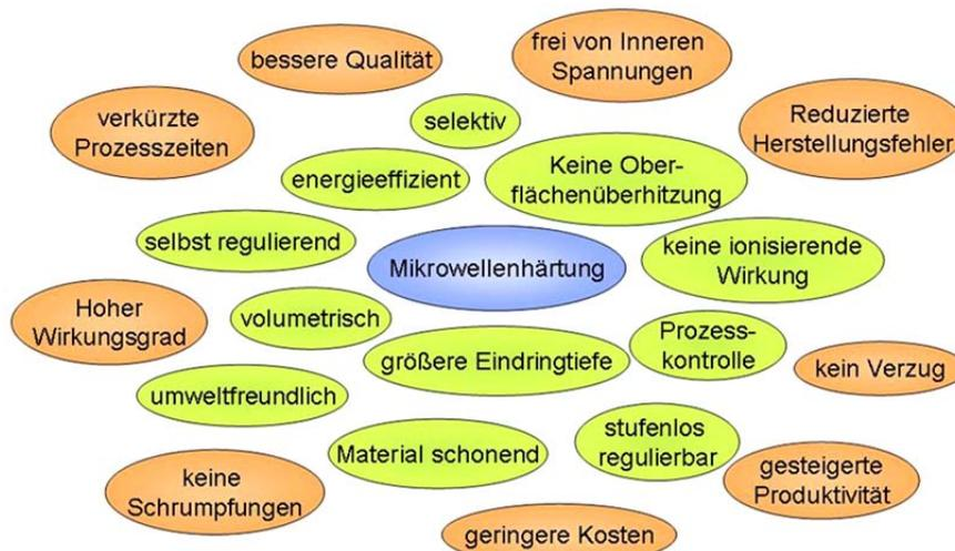
Abbildung 2.5: Vorteile der Mikrowellentechnik (grün) und die Auswirkungen auf die Produktion von Bauteilen (orange)
