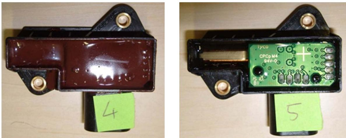
Abbildung 6.22: Vergossene und in der Mikrowelle gehärtete Proben
