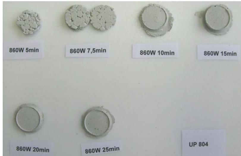
Abbildung 5.75: Vorversuche UP 804, Polyesterformmasse
