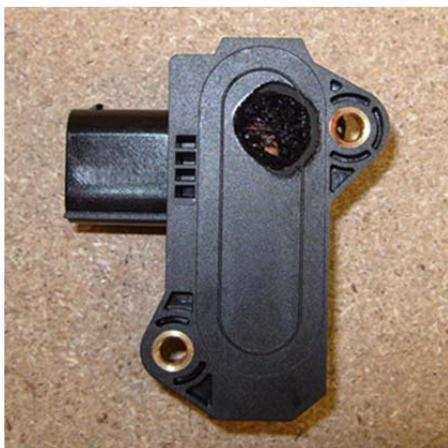
Schädigung des Sensormoduls durch lokale Überhitzung
