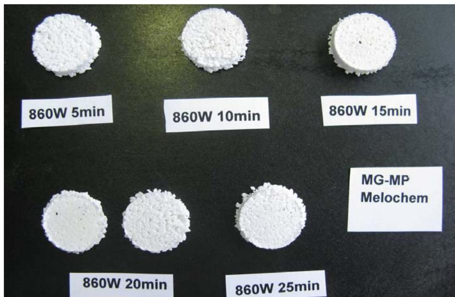
Abbildung 5.80: Vorversuche MG-MP Melochem, Melaminformmasse
