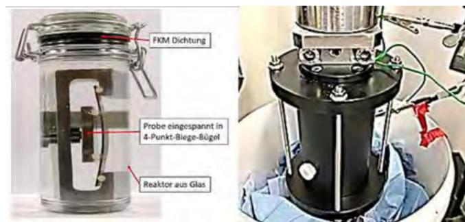
Abb. 1: Versuchsaufbau zur 4-Punkt-Biegeprüfung (links) und im Projekt konstruierte elektrochemische Messeinrichtung in einer servohydraulischen Zug-Druck-Prüfanlage (rechts)
