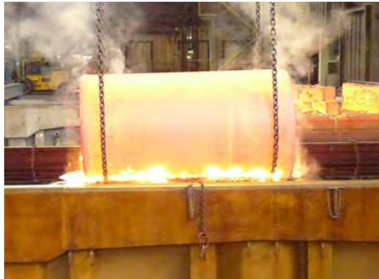
Herstellung des Schmiedestücks aus dem untersuchten MarBN-Stahl bei der Saarschmiede (Blockdurchmesser 1300 mm, Blockgewicht: 35 Tonnen)
