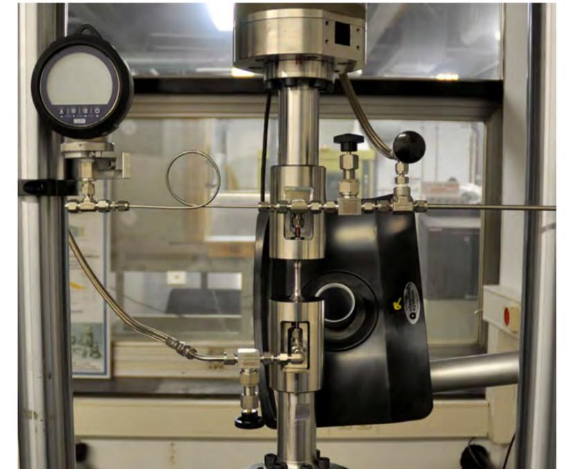
Abb. 2: Prototyp des Hohlprobenprüfstands für das neu geschaffene H2HT-Lab
