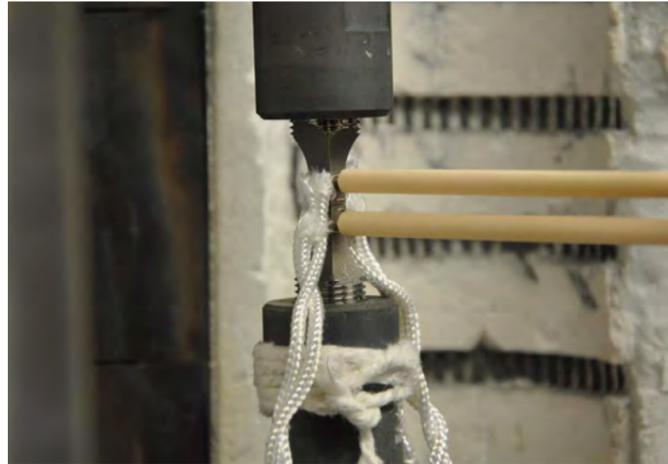
Weiterentwickelter Prüfstand u.a. mit applizierter hochempfindlicher Wechselstrompotenzialsonde zur Charakterisierung des HT-Schwellenwertverhaltens
