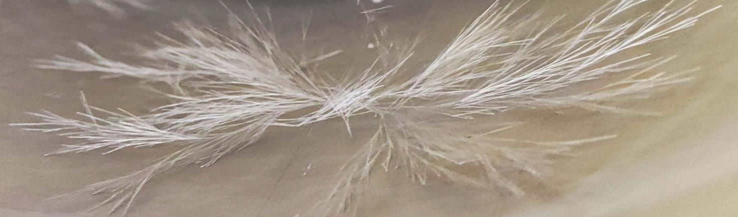
Abb. 1: Whiskerbildung in fluoriertem Isoliergas
