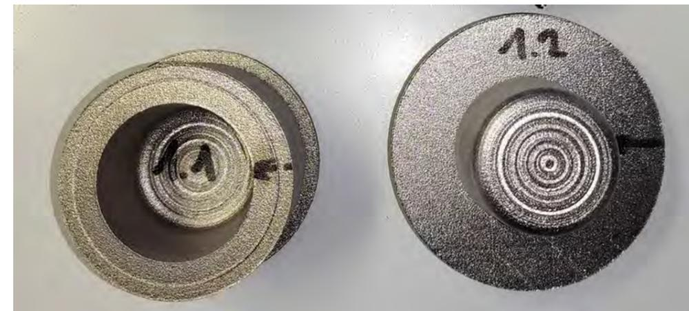
Abb. 2: Additiv gefertigte Duroplast-Werkzeugeinsätze aus 1.2709
