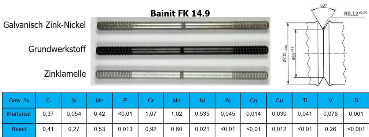
Abbildung 1: Chemische Zusammensetzung und Kerbgeometrie der untersuchten Proben.
